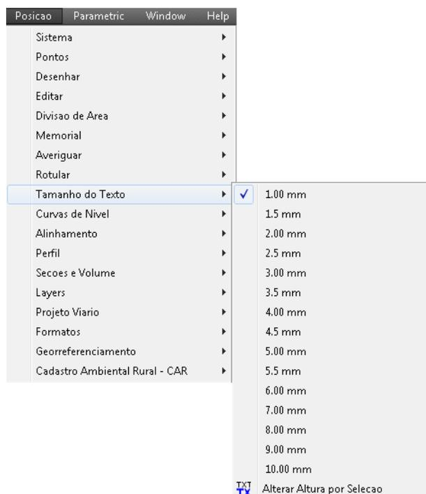
A exemplo, se determinarmos um tamanho de texto igual a 1.00 mm, e gerarmos qualquer informação textual, estes terão 1.00 mm de altura como especificado. Porém, após estes textos já estarem na tela do AutoCad, e desejar alterar as suas respectivas alturas voltando na ferramenta Posição >> Tamanho do texto e alterando para 5.00 mm, os textos que outrora estavam com 1.00 mm continuarão com o tamanho de 1.00 mm, os próximos textos inseridos na tela é que terão 5.00 mm de altura.
